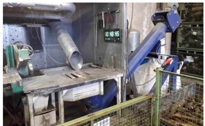
Jeder Arbeitsplatz verfügt über zwei Absauganlagen
