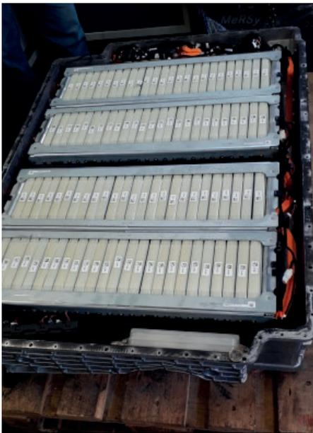
Der Akku wird zunächst bis auf Stack-Ebene demontiert
