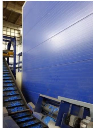
Die Schredderanlage ist zum Schallschutz eingehaust
