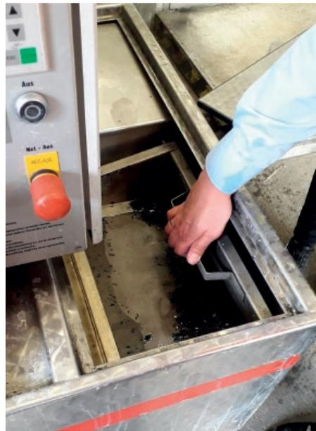
Die abgewaschenen Beschichtungen werden in einem Sieb aufgefangen
