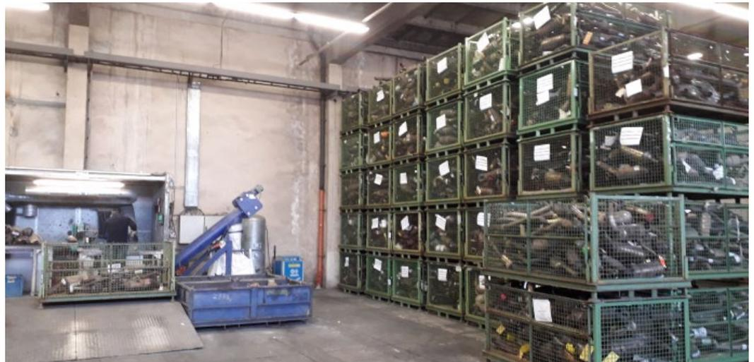
Hier erfolgt das Recycling der Katalysatoren (rechts die angelieferten Katalysatoren; links im Bild die beiden Arbeitsplätze)
